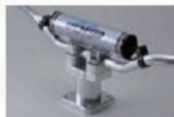
パークランプは、デフォルトでファットバー対応。標準装備のスペーサーを使用することで、スタンダードバーにも対応できる。
